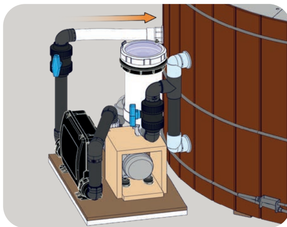
5 > Posez le groupe technique sur la platine.
